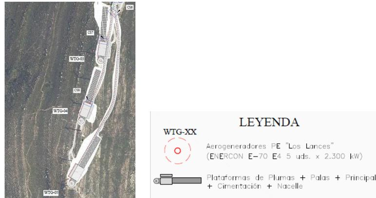
La construcción de estas infraestructuras, junto a los trabajos de apertura/acondicionamientos de los **viales internos**, suponen la excavación del terreno en un volumen total de **148.221,42 m³**, y una ocupación del territorio, unicamente con las plataformas de montaje, de **3,13 has**.
